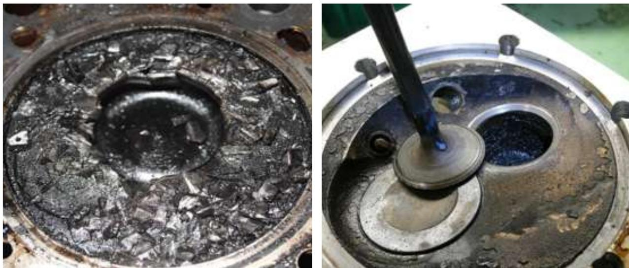
применяемые современные клапанные седла не предотвращают прогорание, когда на автомобиле используется газ без предварительной обработки или без специальных присадок
