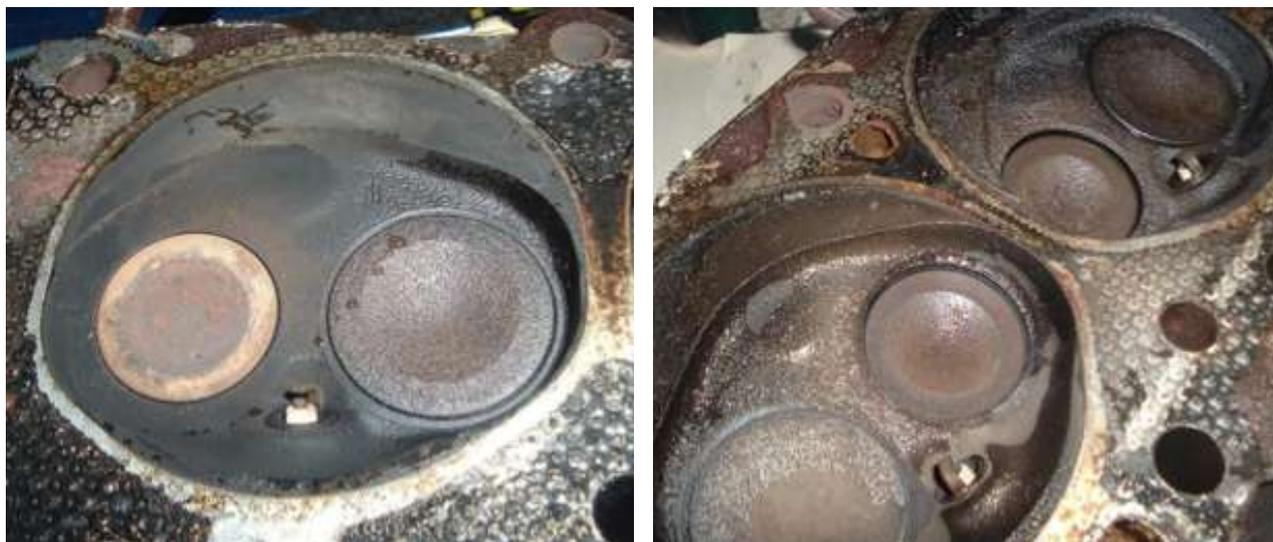
клапана и клапанные седла предрасположены к коррозии и эрозии при использовании LPG, что проявляется потерей мощности, **увеличением расхода топлива до 10% и вредных выбросов**
