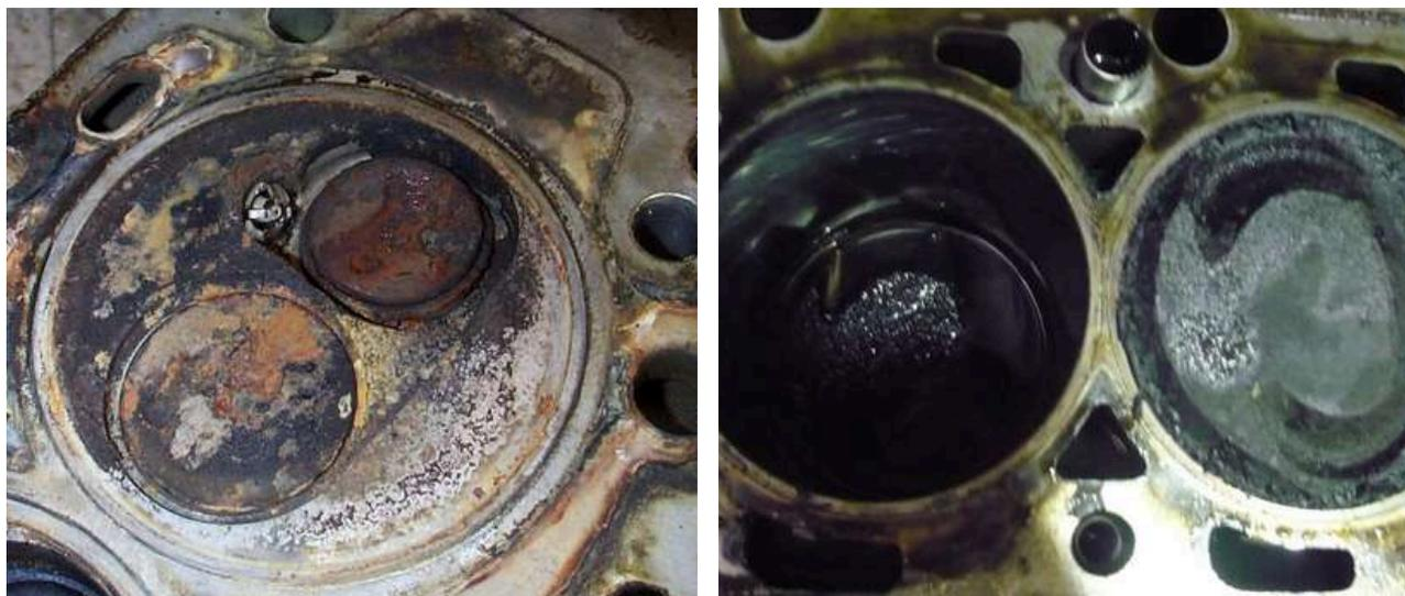
недостаток смазки и более высокая температура горения газа (LPG) часто приводит повреждению выпускных клапанов, к феномену известному как **«прогорание клапанных седел»**
